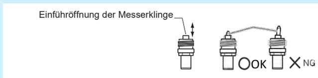
Wenn sie nicht richtig installiert ist, kann es zu Schäden an der Messerklinge oder dem Plotter selbst führen.
