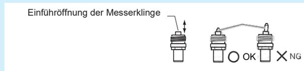
Wenn sie nicht richtig installiert ist, kann es zu Schäden an der Messerklinge oder dem Plotter selbst föhren.
