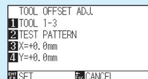
Sie können zwischen „Tool 1-3“ und „Tool 1-2“ umschalten, indem Sie die Taste [1] drücken.
